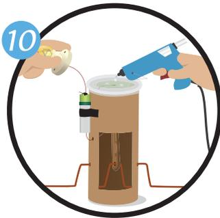
Pega el bombillo con silicona o pegamento de contacto con su portalámparas en el cilindro de cartón. haga contacto con el cable del pistón.
