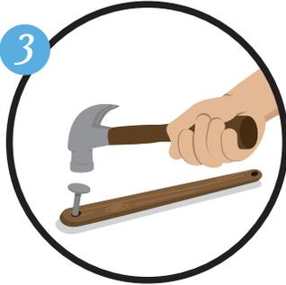
Para realizar la biela de nuestro motor, utiliza el palo de madera. Haz una perforación con un clavo delgado y un martillo a 1cm de su base. Puedes usar también un trozo de alambre de cobre de la misma longitud (10 - 12 cm).
